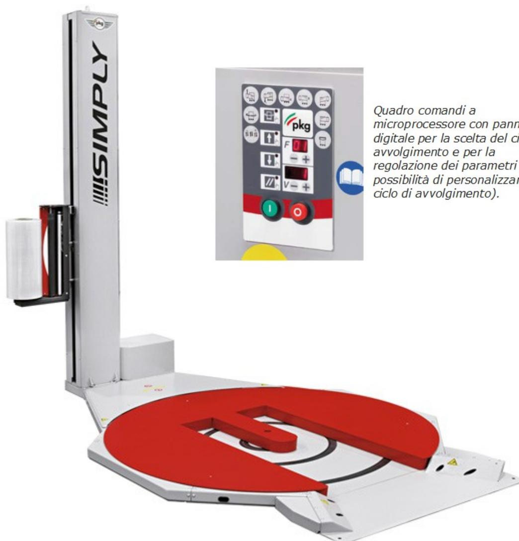
*Quadro comandi a microprocessore con pannello digitale per la scelta del ciclo di avvolgimento e per la regolazione dei parametri (con possibilità di personalizzare il ciclo di avvolgimento).*
