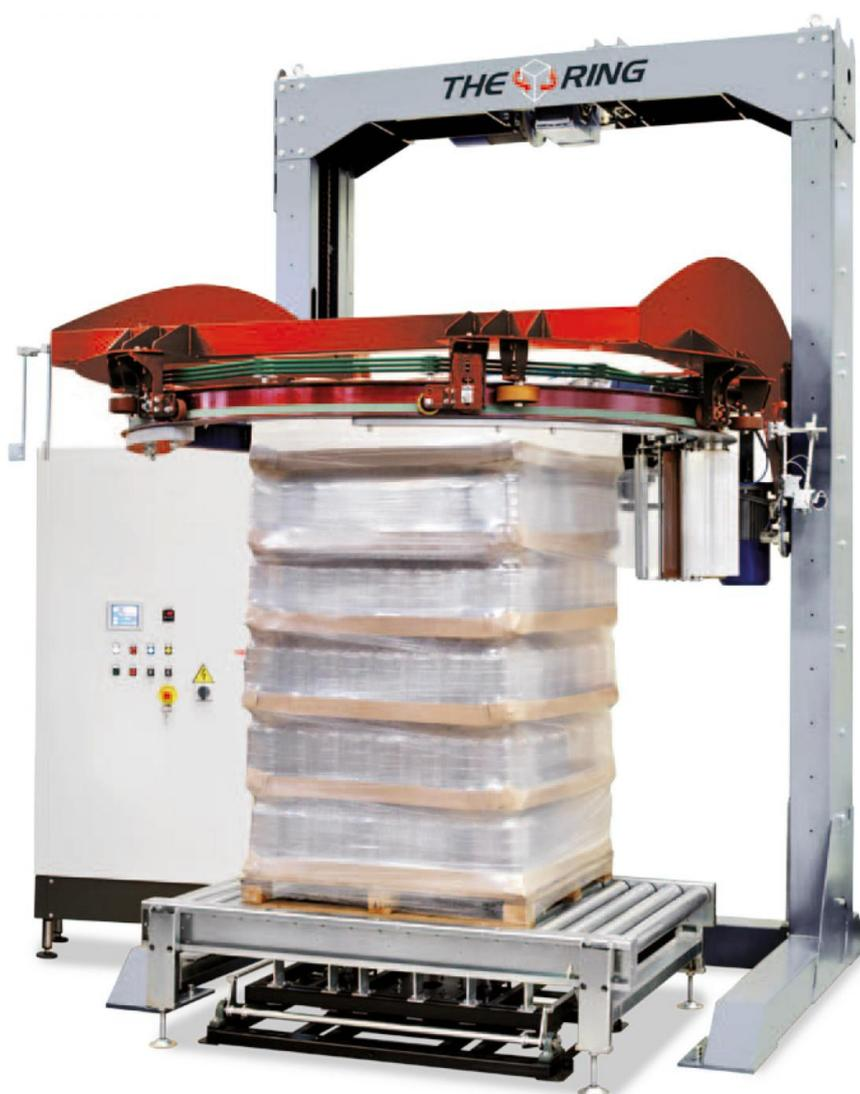
Una macchina a prestiro esterno, che non utilizza contatti elettrici sull'anello o altri sistemi complicati e costosi di generazione di corrente. E' in grado di raggiungere una velocità di 140 pallet/h. Disponibile anche in versione 2 bobine.
