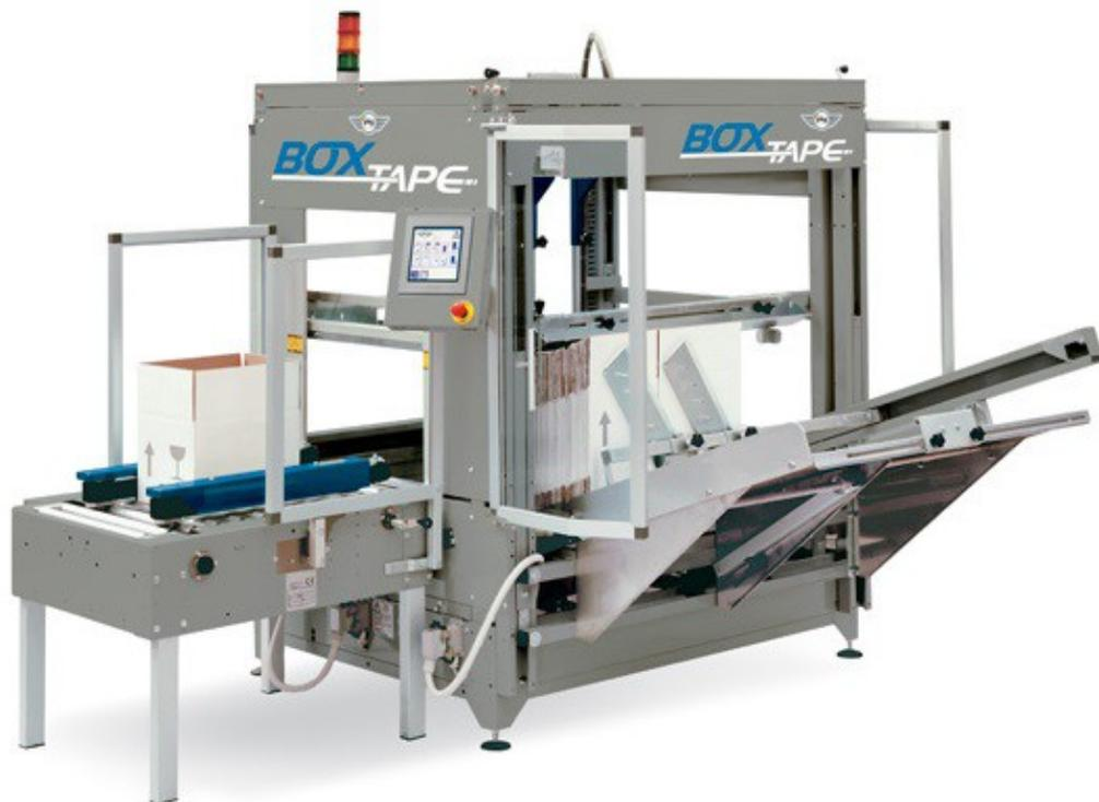
**Formatore automatico di scatole. Semplice e con veloce regolazione per il formato della scatola preleva dal magazzino laterale e ripiegandone le quattro falde inferiori la scatola viene nastrata pronta per essere riempita.**
